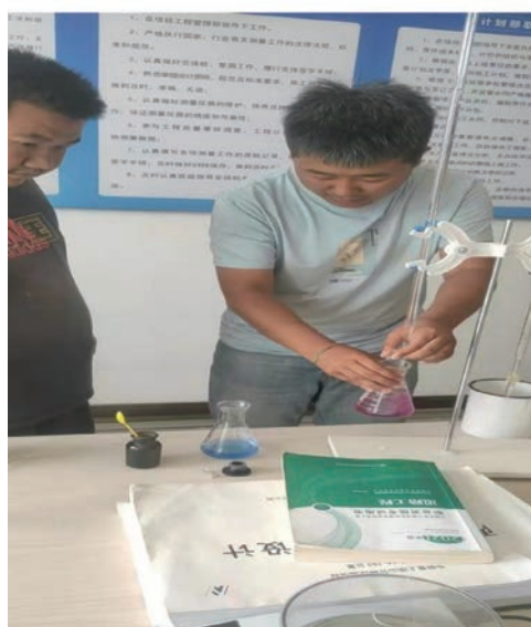
图9 EDTA测定水泥剂量
