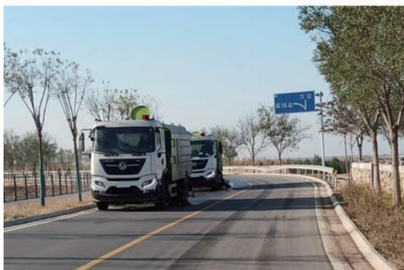
图 1 冲洗车日常道路洒水保洁
