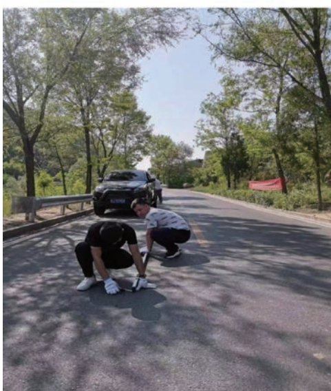
图8 检测路面平整度
