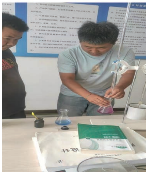
图 9 EDTA 测定水泥剂量
