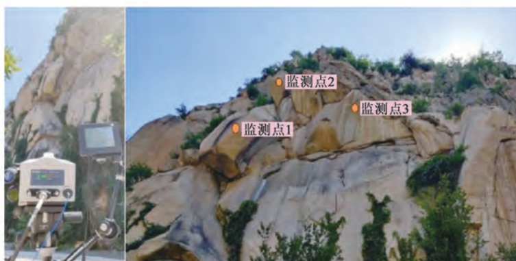
图 12 边坡预警系统和岩体监测
