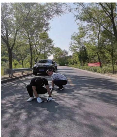
图8 检测路面平整度
