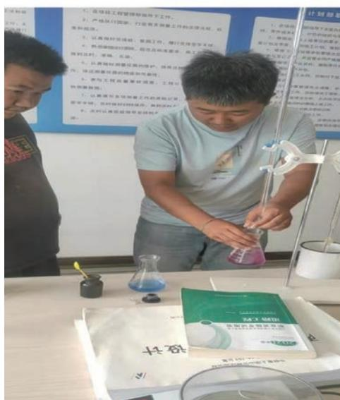
图9 EDTA 测定水泥剂量
