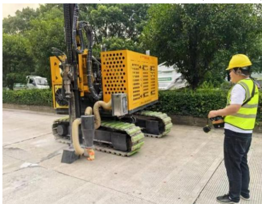
图 8 遥控智能钻孔机
