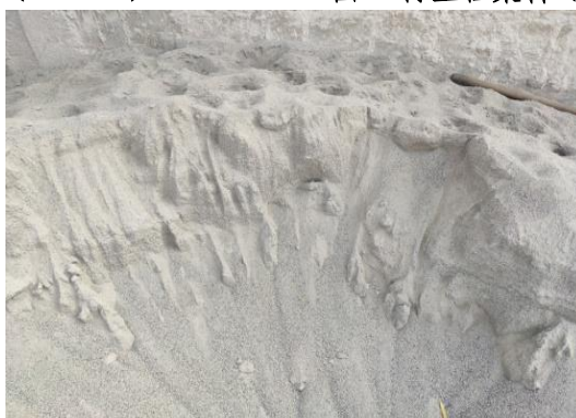
图 4 再生粗集料 (RCA-1) (5-15mm)
