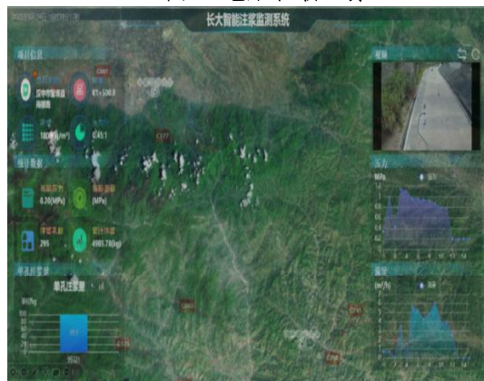
图 11 注浆实时智能监测系统
