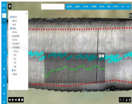
图 6 智能声波脱空检测结果
