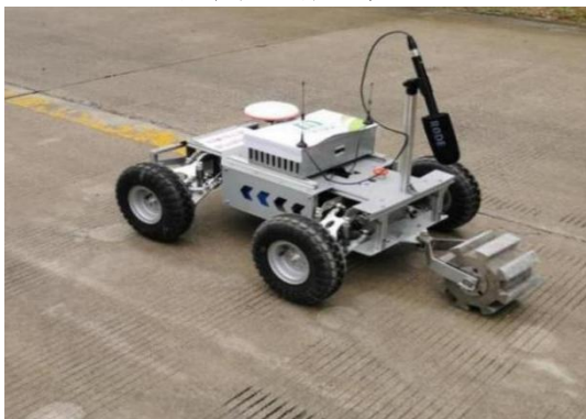
图 4 水泥路面智能声波脱空检测仪
