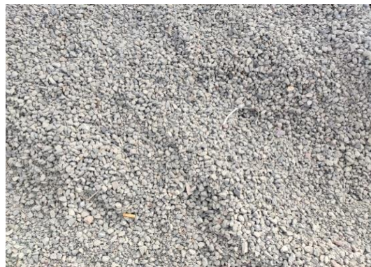
图 3 再生粗集料 (RCA-2) (15-31.5mm)
