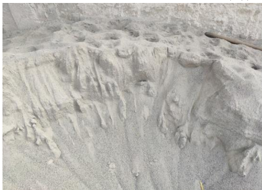
图 4 再生粗集料 (RCA-1) (5-15mm)
