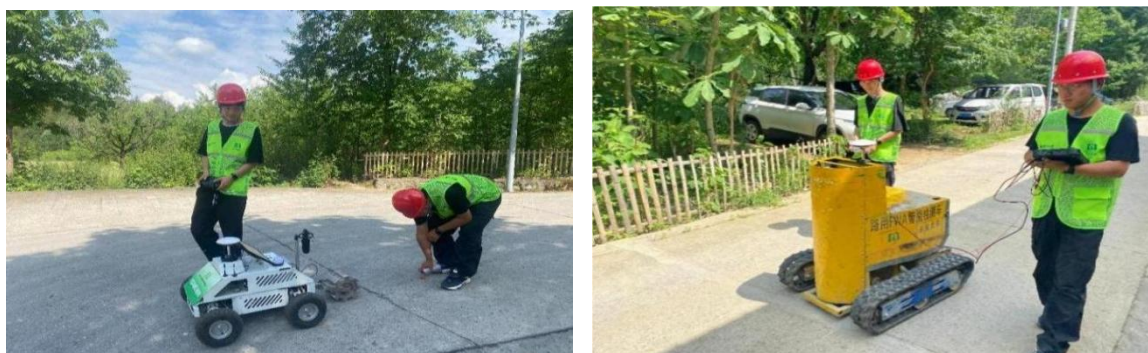
图 5 水泥路面板底脱空及路用 FWA 智能检测
