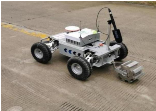
图 4 水泥路面智能声波脱空检测仪
