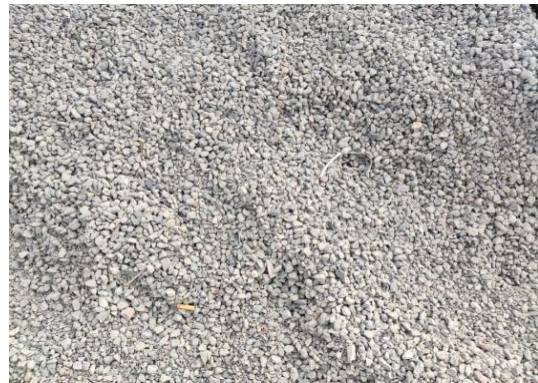
图 3 再生粗集料 (RCA-2) (15-31.5mm)
