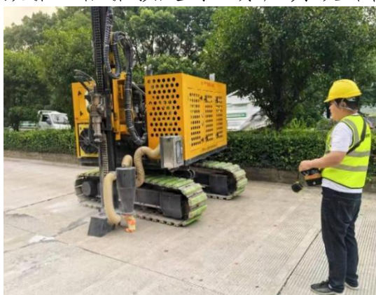
图 8 遥控智能钻孔机
