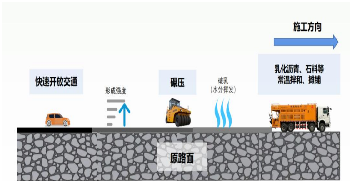
图 1 ARCP 高抗飞散冷拌超薄罩面施工工艺图
