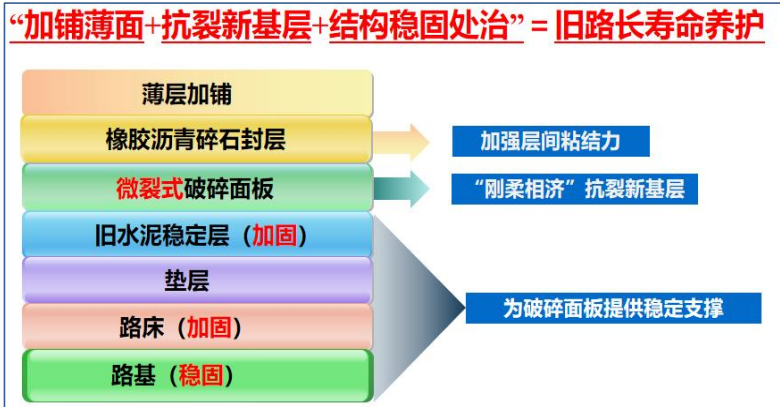
图 1 全过程数字化水泥路面微裂均质化薄层加铺技术核心理论
